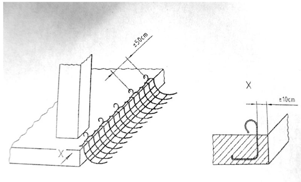
Puntos de anclaje para la sujeción del borde inferior de la red de seguridad al edificio mediante una cuerda perimetral
